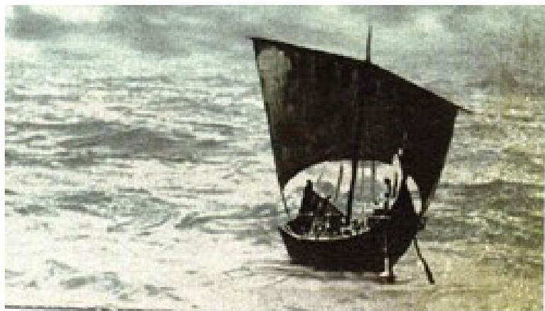
Il navicello era una barca lunga dai 12 ai 20 metri, larga circa 2,8 e con una stazza di 25 tonnellate, trasportava sabbia o talvolta mattoni prodotti a Fornacette. Per arrivare da Calcinaia a Livorno, a pieno carico, impiegava 4-5 ore. Di solito restava nel centro del fiume mentre i navicellai scende-
